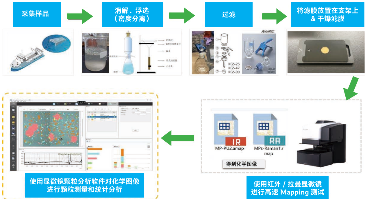
图2 微塑料前处理及分析流程示意图
