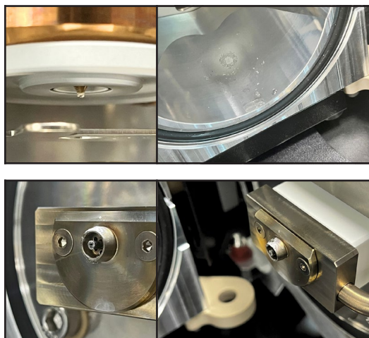
图 3 两次海水直接进样后 LC-MS/MS 离子源各部件的盐积聚情况
