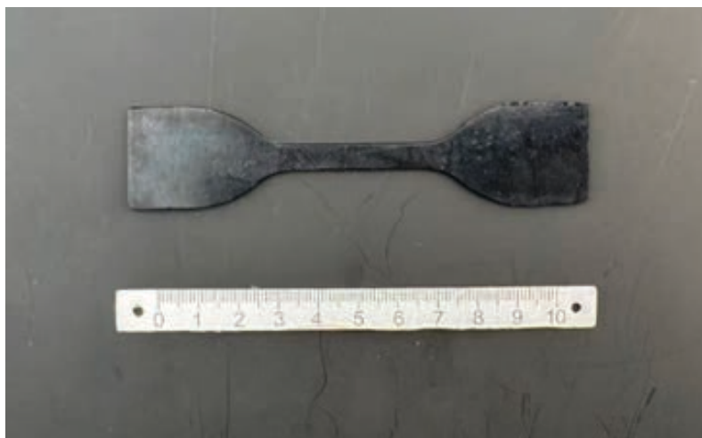
图3 POE 哑铃型拉伸试样
