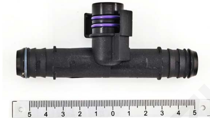
图 2. 锂电池冷却管道外观图
