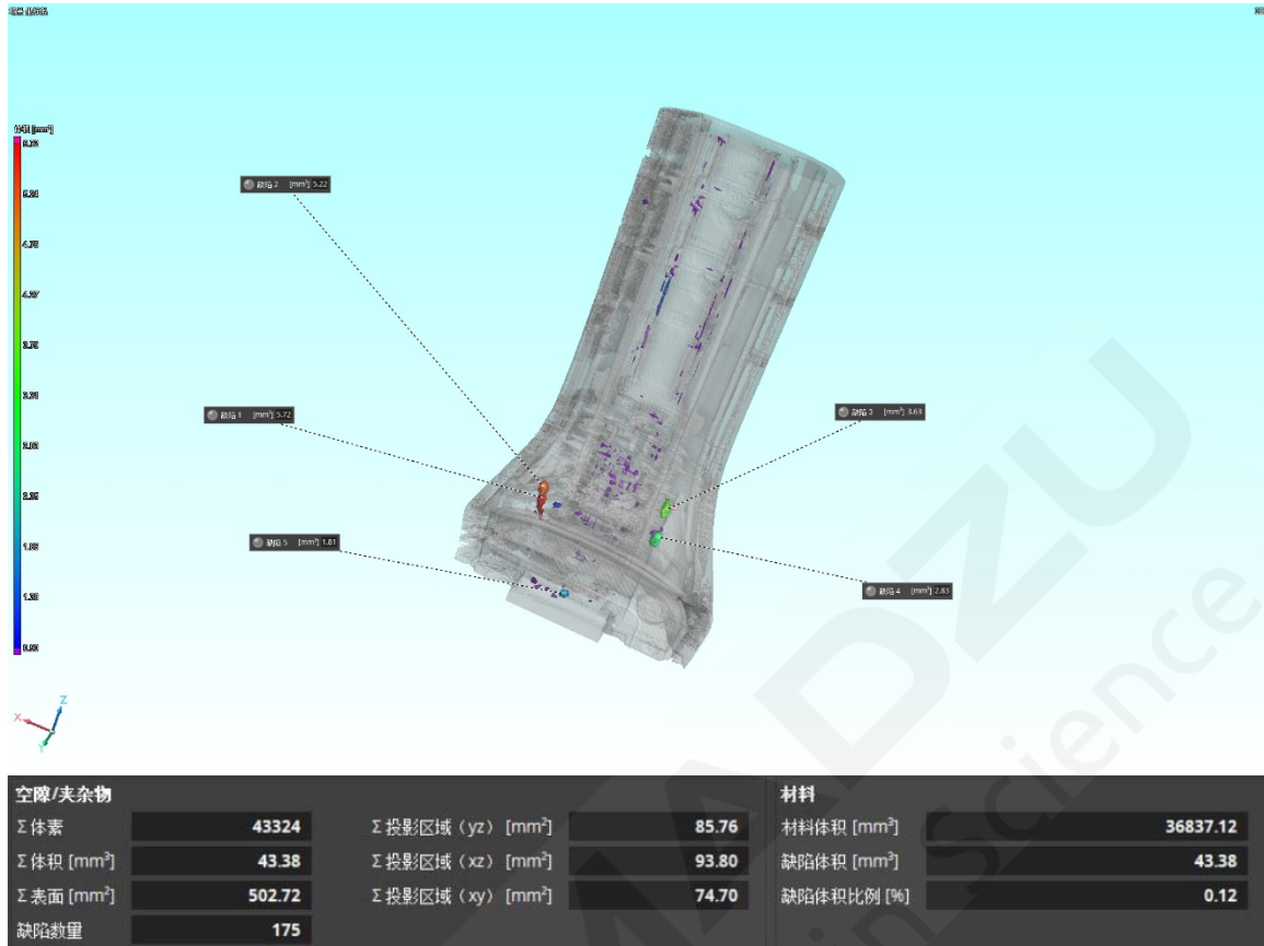
图 5. 汽车门把手孔隙率分析
