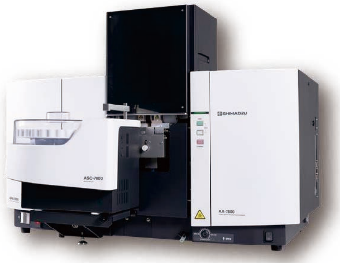
图 1 岛津 AA-7800 原子吸收分光光度计
