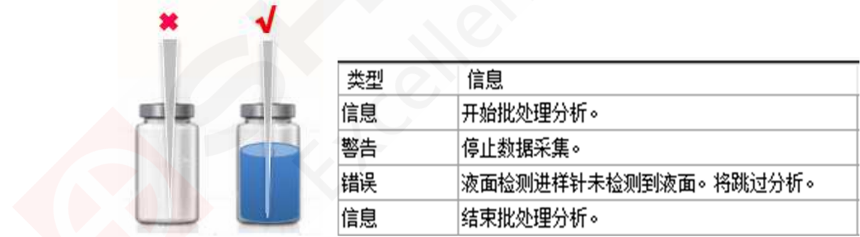
图 5. LH-40 液面检测功能
