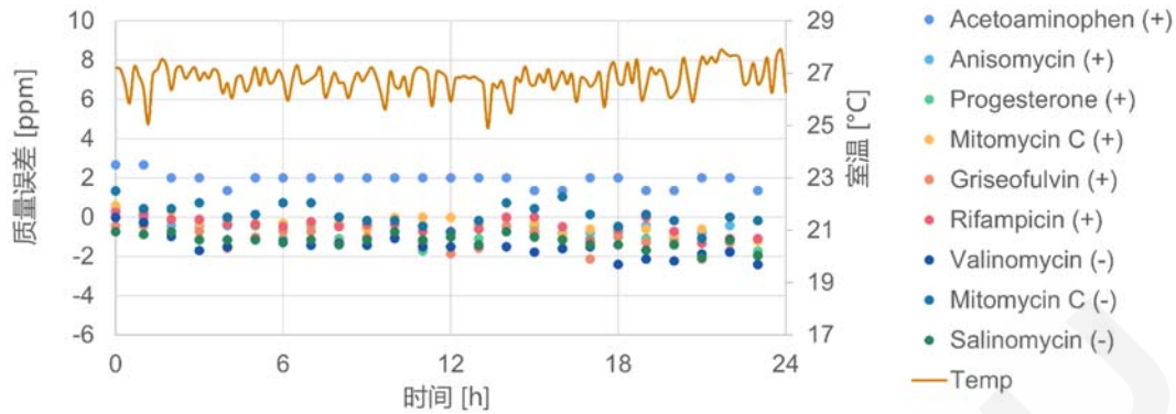
图 8. 快速正负离子切换模式下的质量数稳定性测试结果（分子量：150~1200 Da）
