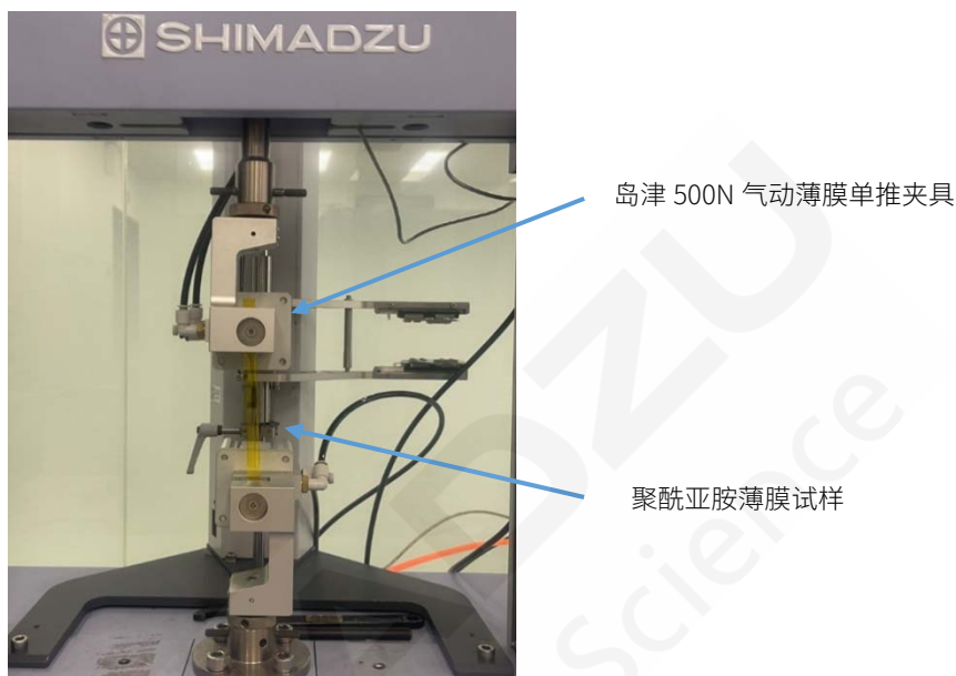
图 2. 测试系统构成与夹具、样品特写
