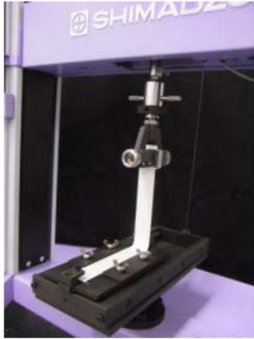
图1 测试系统图（主机、夹具）
