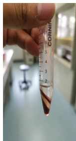
图5 加入过量 NaCl 后乙腈与血液分层（上层为乙腈层）
