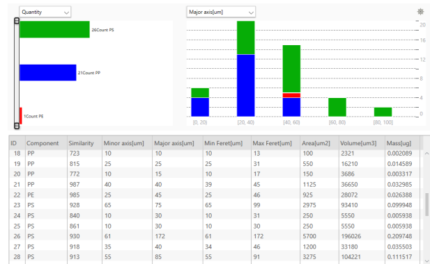
图 10: 使用颗粒分析程序对不锈钢滤膜上颗粒进行分析的结果
