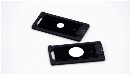
图 3：（滤膜支架）下托正面固定 PTFE 滤膜的照片
