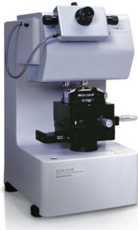
图1. DUH-211S动态超显微硬度计和可吸收外科缝线样品
