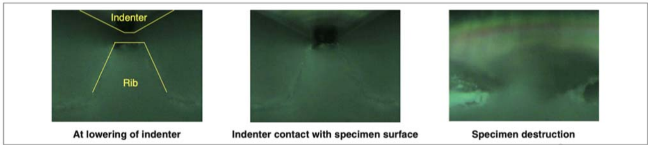
图 4. 侧向 CCD 观察图像（压缩断裂过程）
