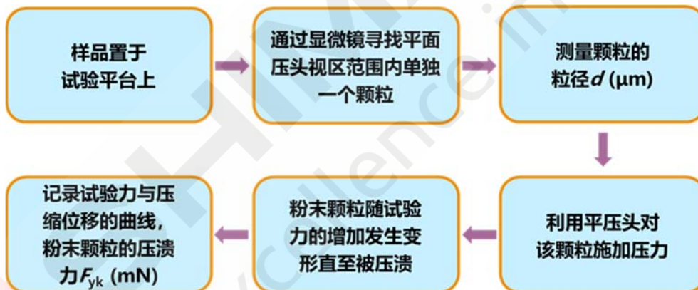
图2. 测试方法原理图
