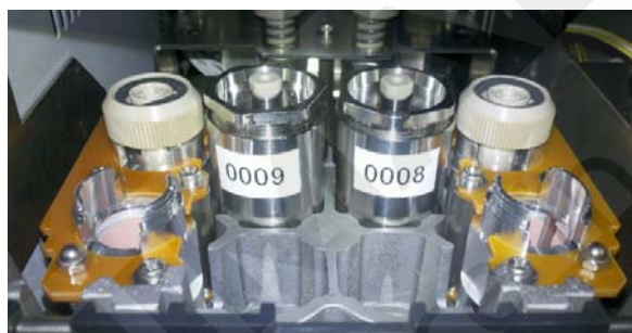
图 1 安置在回收系统中的 C2P 色谱柱及样品回收瓶 后处理泵的多种流动相用于 C2P 色谱柱的使用后清洗和日常维护。
