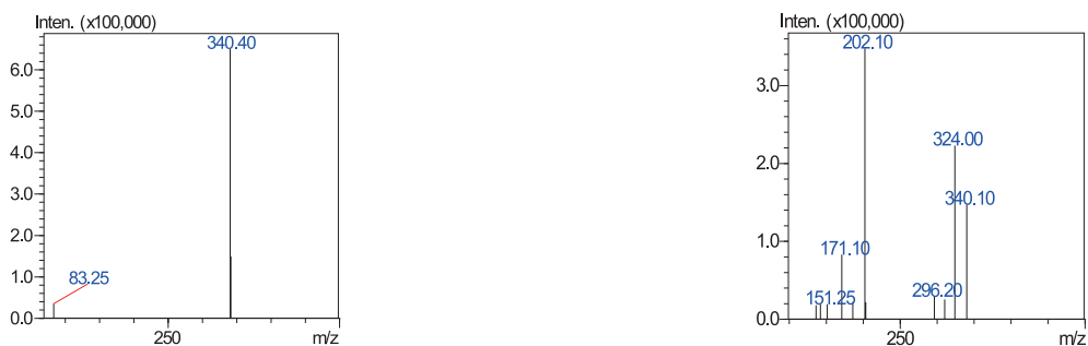
图3 罂粟碱的一级质谱图 (左图) 和产物离子质谱扫描图 (CE值为-30V) (右图)
