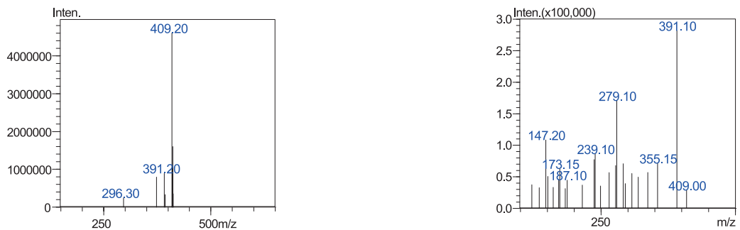
图10 倍氯米松一级质谱扫描图 (左图) 和产物离子质谱扫描图 (右图) (CE: -20V)
