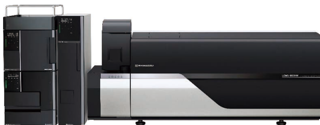
图 1: Nexera™ 和 CMS™-8060NX. 离子聚焦设计可在更高的气体流量和更高的有效温度下提高信号强度。
