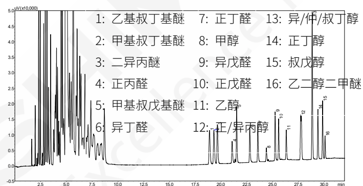
图 7. 汽油空白色谱图(6.1 min 反吹)
