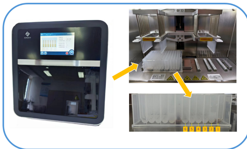
图 1 前处理设备外观、内部结构及上机深孔板
