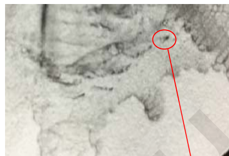
图2 样品2过滤后图片（红圈内黑色粒子是微珠）
