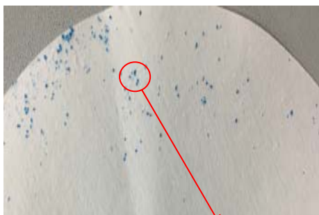
图1 样品1过滤后图片（红圈内蓝色粒子是微珠）
