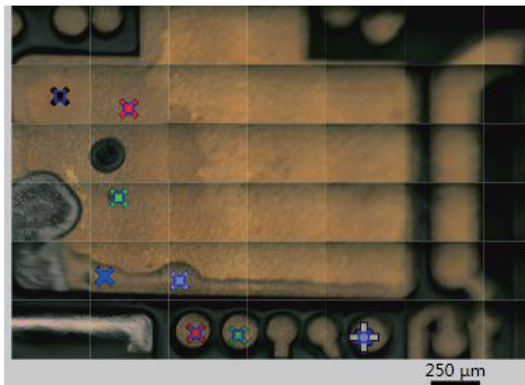
图3 左侧焊锡附近电路板红外显微镜下照片, 标记处为测试点
