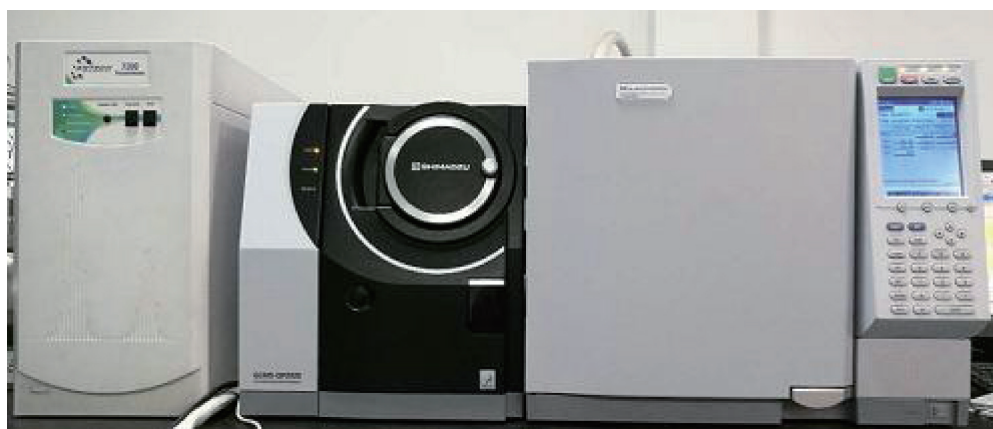
图1 ENTECH 7200+岛津GCMS离线检测系统
