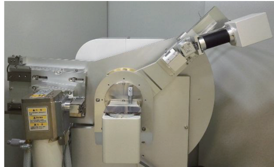
图3 掠入射非对称衍射几何实物图
