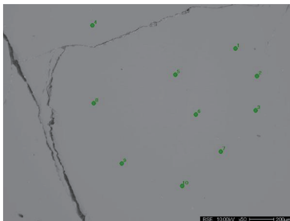
图12 试样绿柱石背散射电子像和测试点位图
