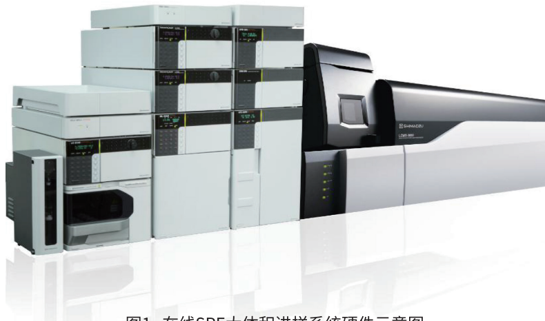
图1 在线SPE大体积进样系统硬件示意图
