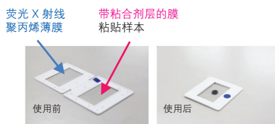
图 3 异物测定保持、储存容器 EDXIR-Holder
