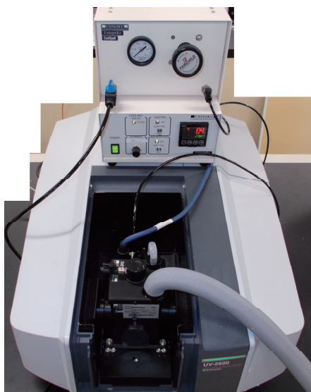
图 1 在 UV-2600 安装 CoolSpeK 的情况
