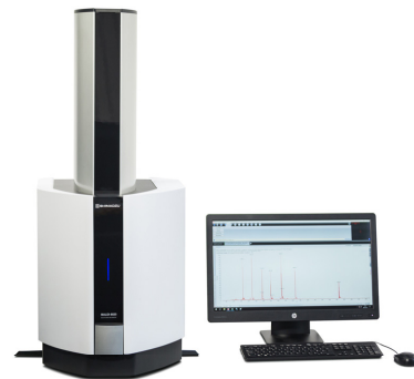
图 1 台式 MALDI-TOF MS MALDI-8020
