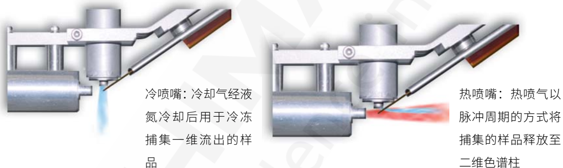
图 3. 岛津全二维气相色谱质谱联用仪调制解调器工作原理示意图
