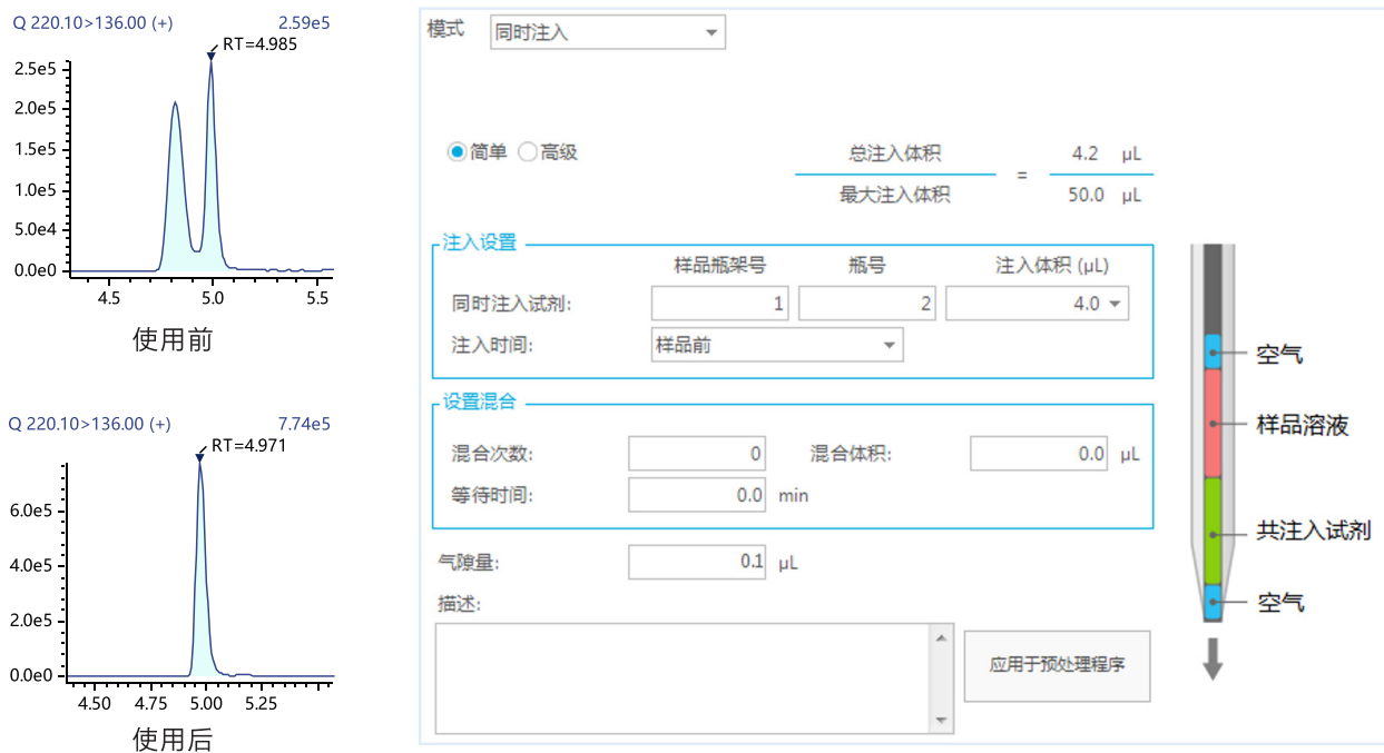
图 3 使用 co-injection 前后色谱图以及同时注入功能参数设定界面
