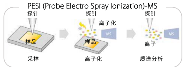
图 1 DPiMS™-2020 和探针电喷雾电离法的原理 将探针插入样品板上的样品中， 并向附着在探针表面的样品施加电压以使分子电离。
