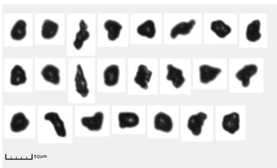
图 4 聚丙烯材质 3D 打印材料粒形图 (c)
