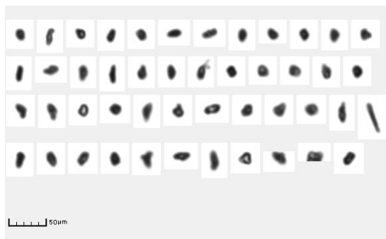
图 3 聚丙烯材质 3D 打印材料粒形图 (b)
