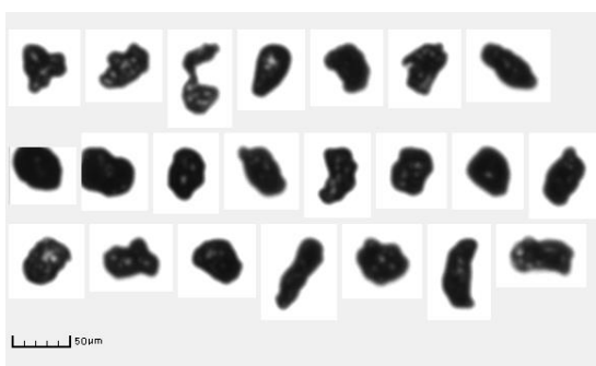
图 5 聚丙烯材质 3D 打印材料粒形图 (d)
