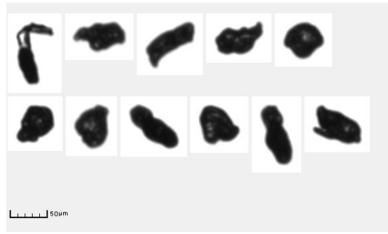
图 7 聚丙烯材质 3D 打印材料粒形图 (f)
