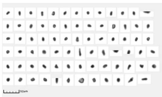
图 2 聚丙烯材质 3D 打印材料粒形图 (a)
