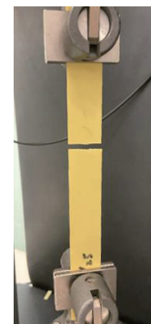
图 2 5KN 气动双推夹具拉伸测试
