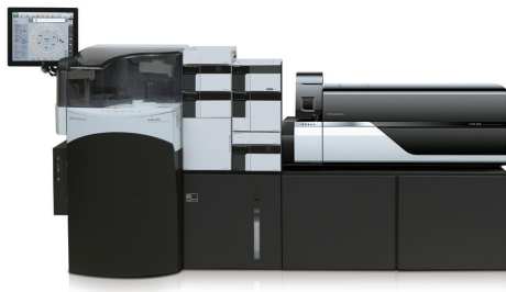
图 1 带全自动预处理装置的 LC/MS/MS 系统 (CLAM™+LC/MS/MS)
