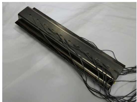
图 2 应变片粘接方式
