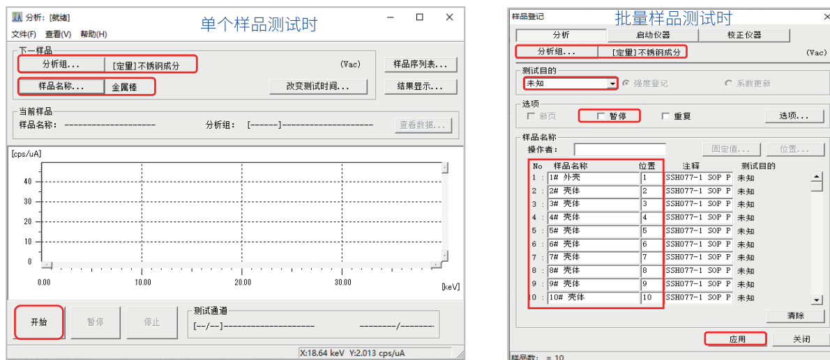
图 11 样品分析操作步骤 (EDX Pro)
