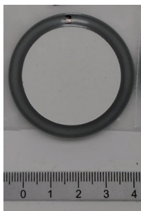
图 1 制备好的 XRF 压片样品
