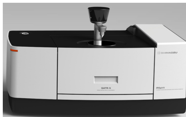
图 1 安装 ATR 附件的 IRSpirit-T
