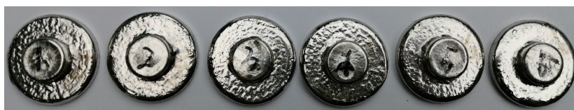
图 2 锡铋银合金焊料标准样品
