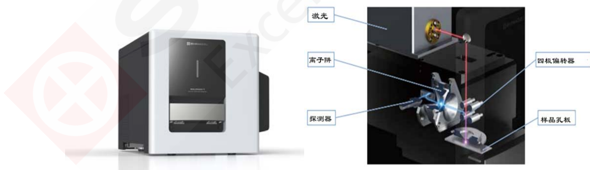
岛津 MALDImini-1 离子阱质谱仪及内部结构
