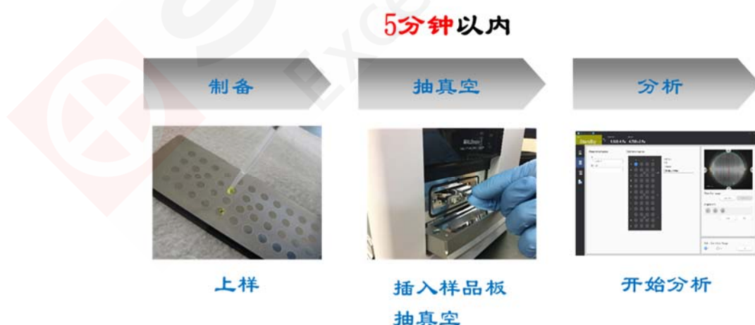
图 2. MALDImini-1 上机分析流程图
