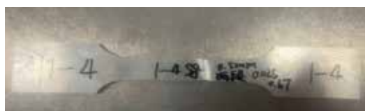
图 8 铝板试验破坏位置良好
