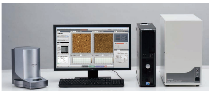
图 1 扫描探针显微镜 SPM-9700HT
