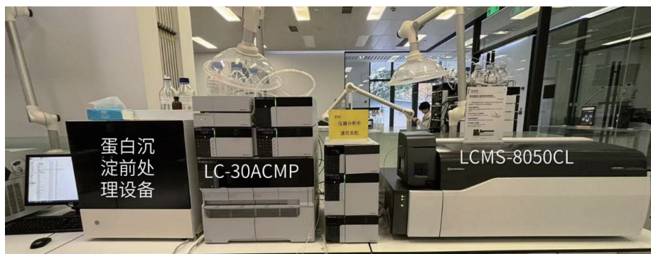
图 1 在线前处理设备及与岛津 LCMS 设备联机示意图
