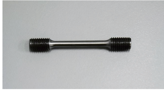
图 1 样品尺寸图片 (总长 66 mm)
