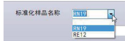
3.40 在 [ 标准化样品名称 ] 项选择标准化样品名称，并将客户的标准化样品中对应的标准化样品放到激发台上进行强度分析。
