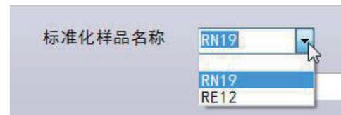
3.35 在 [ 标准化样品名称 ] 项选择标准化样品名称，并将基准标准化样品中对应的标准化样品放到激发台上进行强度分析。
