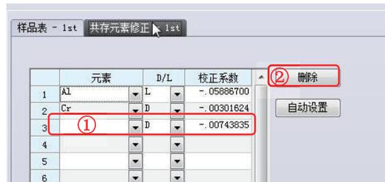
3.26 对于有多条工作曲线的通道，每一条工作曲线的 [ 共存元素修正 ] 内容都要确认。
