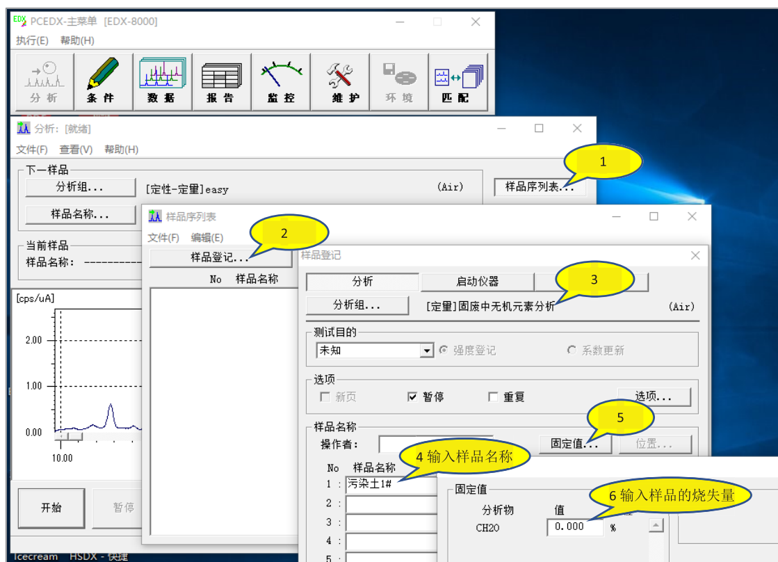
图 6 测试前样品的烧失量输入方法示意图
