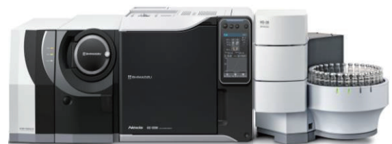
图 2 配备 HS-20 系统的 GCMS-TQ8050 NX
