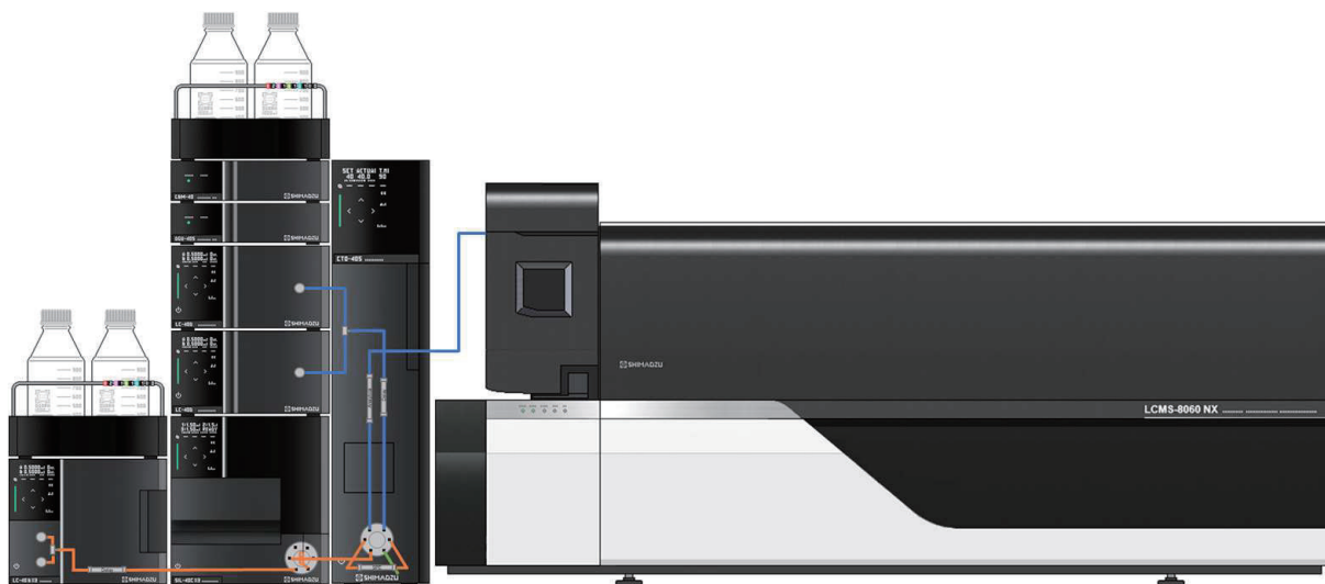
图 3 NexeraTM 在线 SPE LCMS-8060NX 系统示意图
