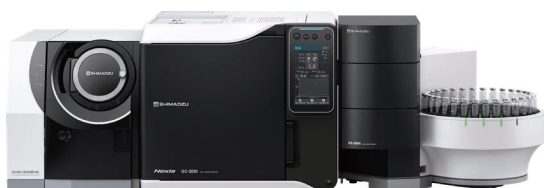
图 1 HS-20 NX (捕集阱型) 与 GCMS-QP2020 NX 联用
