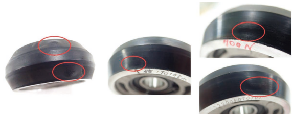
图 3 工件凸起（左：工件 A 上的 2 个位置；中：工件 B 上的 1 个位置；右：工件 C 上的 2 个位置）
