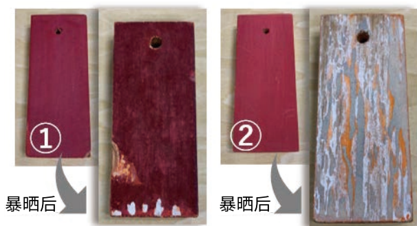
图8 暴晒实验后颜料的外观
