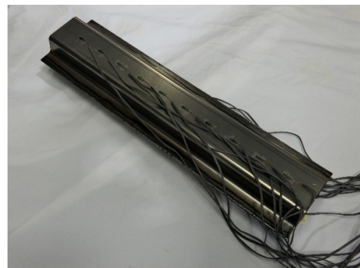
图 2 应变片粘接方式
